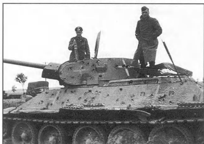
Т-34 в многочисленных «остинах» от вражеских снарядов. Большинство из них не пробили броню. Танк даже не сгорел
