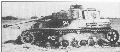
С 1942 г. немцы вооружили свой основной танк Т-IV длинноствольной 75-мм пушкой, уравнив его по огневой мощи с Т-34
