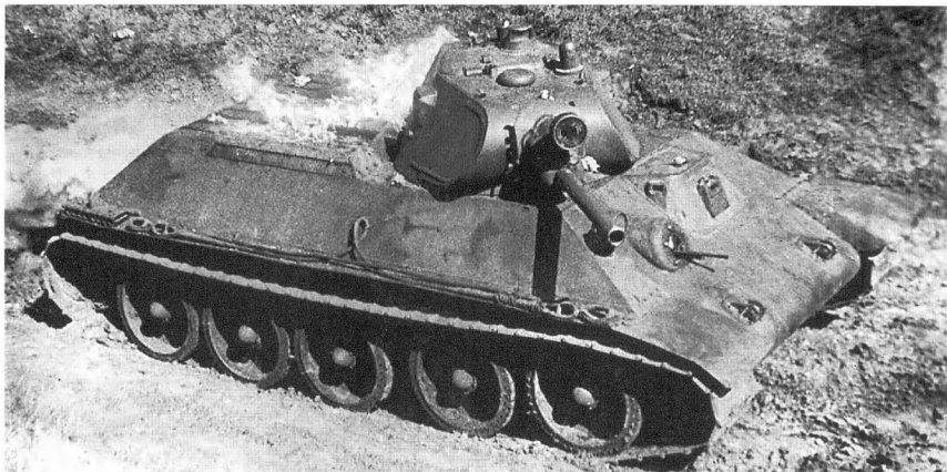
Испытание второго опытного Т-34 на огнестойкость: на моторном отделении горит бутылка с зажигательной смесью. Обратите внимание на необычный люк механика-водителя в крыше
