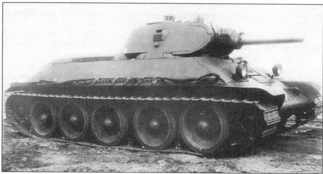
▲ Опытный гусеничный танк Т-32 – прототип Т-34
