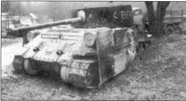
Сербский Т-34 – участник войны в бывшей Югославии. На танк установлена дополнительная броня
