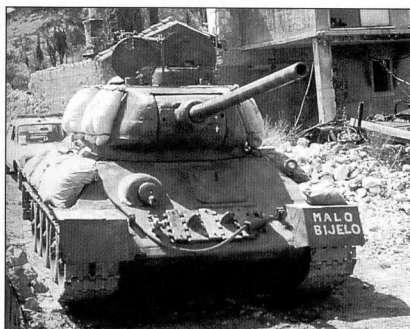
1990-е годы. Хорватский танк Т-34 «Пчелка» во время конфликта в бывшей Югославии. Обратите внимание на дополнительную защиту бортов мешками с
