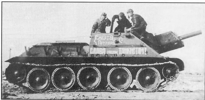
Первая самоходная артиллерийская установка на базе Т-34 – СУ-122
