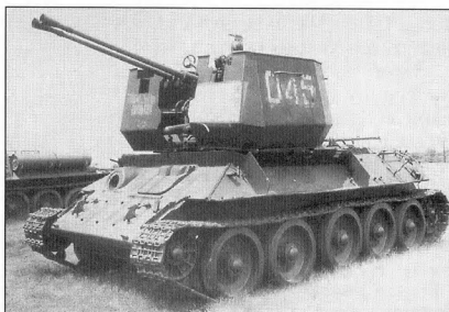
Зенитная самоходная установка на базе Т-34, применявшаяся во Вьетнаме
