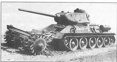
"Инженерный танк" – Т-34, оборудованный катковым минным тралом
