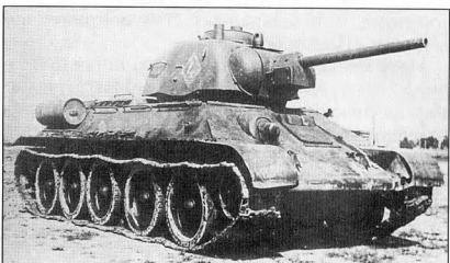
На базе Т-34 выпускался огнемётный танк ОТ-34. Огнемёт устанавливался вместо пулемета в лобовом листе брони.
